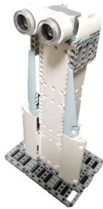
图 2 智能门禁触发装置
