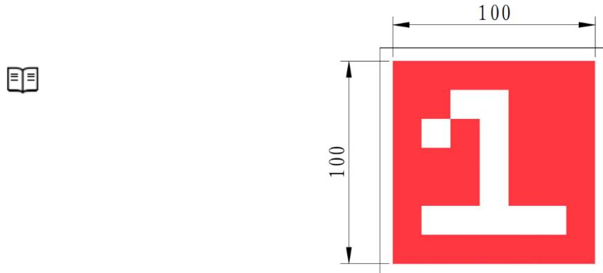
图 2-16 视觉标签有效尺寸示意图
